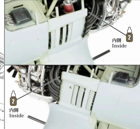
3-4.M~3-4.Pまでの外板は、一度接着せずに仮組みして隙間を調整して見ても良い。
