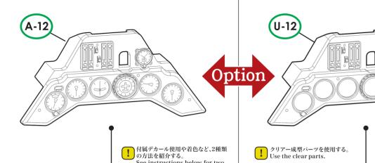
N-25 使用時の計器盤着色方法 How to finish the instrument panel using the grey plastic part (N-25) 付属デカール使用や着色など、2種類の方法
